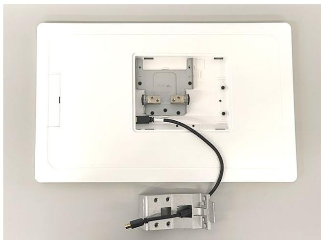
⑥Mini HDMIケーブルをモニターに接続し③で外した金具に
