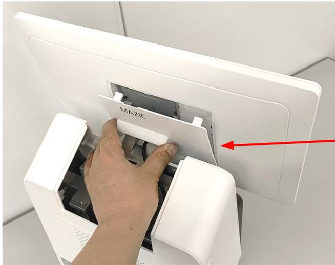
⑪ 横位置画面のときのプラスチックカバーを取り付けます。
